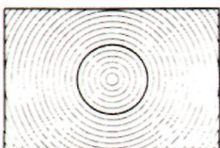
РИС. 3. Экран для обычных видов съемки и съемки движущихся объектов удобен при использовании телеобъективов. Матированное френелевое поле с контрольной 12-мм окружностью и фокусирующей точкой с густой сеткой
