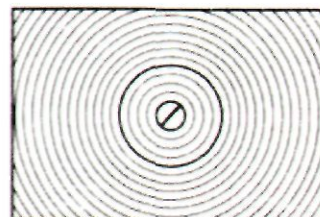
РИС. 10. Экран для обычных видов съемки. Идентичен экрану на рис. 2, но отличается наклонной линией клиньев
