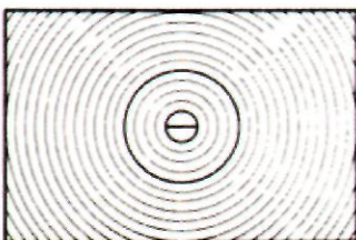
РИС. 2. Экран для обычных видов съемки и съемки движущихся объектов. Матированное френелевое поле с контрольным кольцом диаметром 12 мм и 3-мм кружком с клиньями Додена
